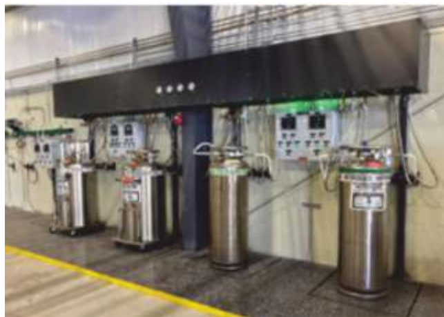
Пример участка наполнения криоцилиндров от компании IGAS.
