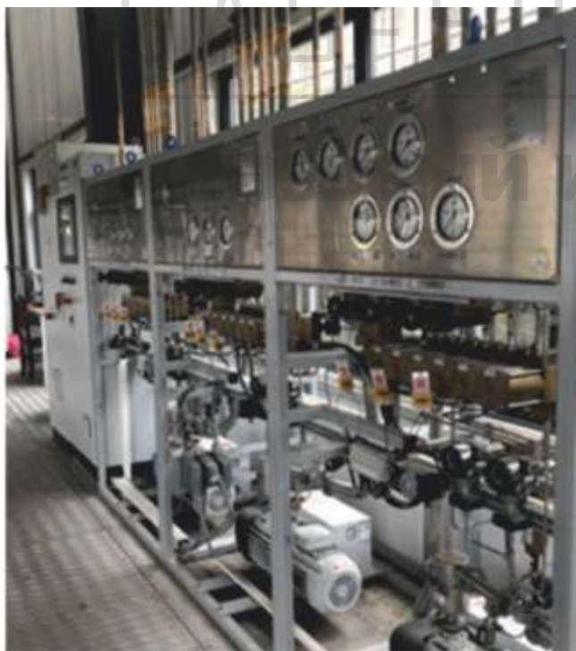
Блок автоматического управления наполнения баллонов с вакуумными насосами от компании IGAS
